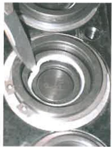
Defekten O- und Stützring ausbauen und Kupplung mit Bremsenreiniger reinigen
